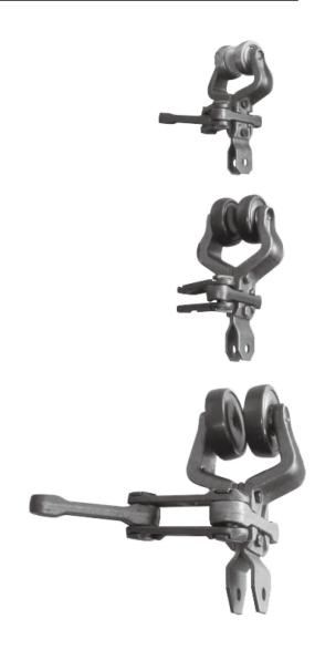
滑架的作用是承受物件,吊具及链条的重量,仔垂直弯曲段还要承受链条张紧的合力,并能保证链条按轴道的线路运行。在线路中两个负载滑架之间距离超过800-900时,可在中间增加一个空载滑架。
